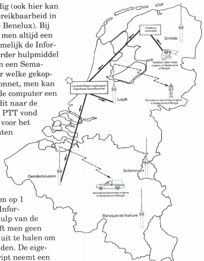
Schematische voorstelling van het openbare semafoonnet in Nederland en België
